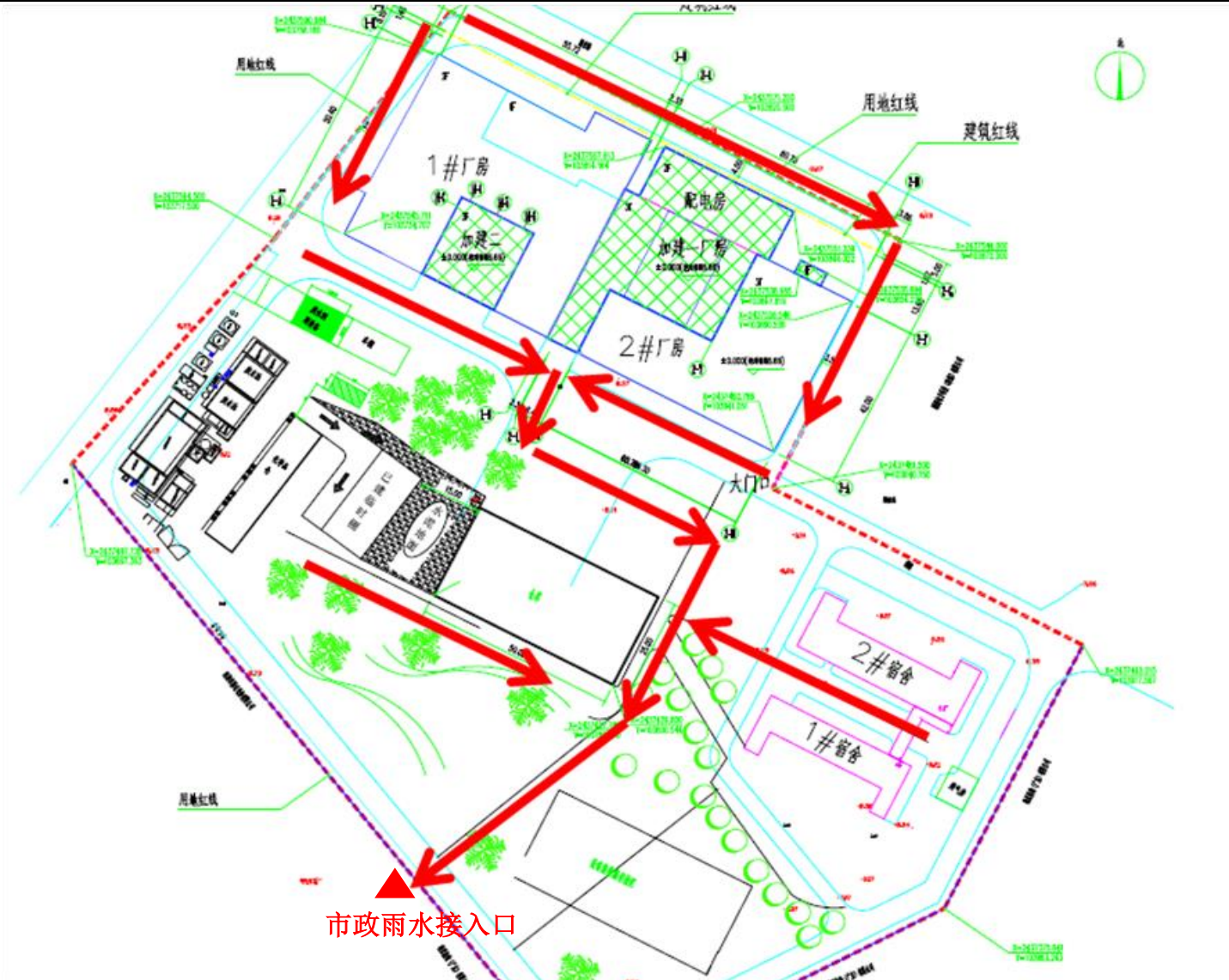
附图 4 厂区雨水管网走向图
