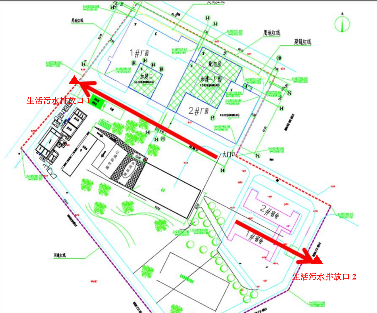
附图 5 厂区生活污水管网走向图
