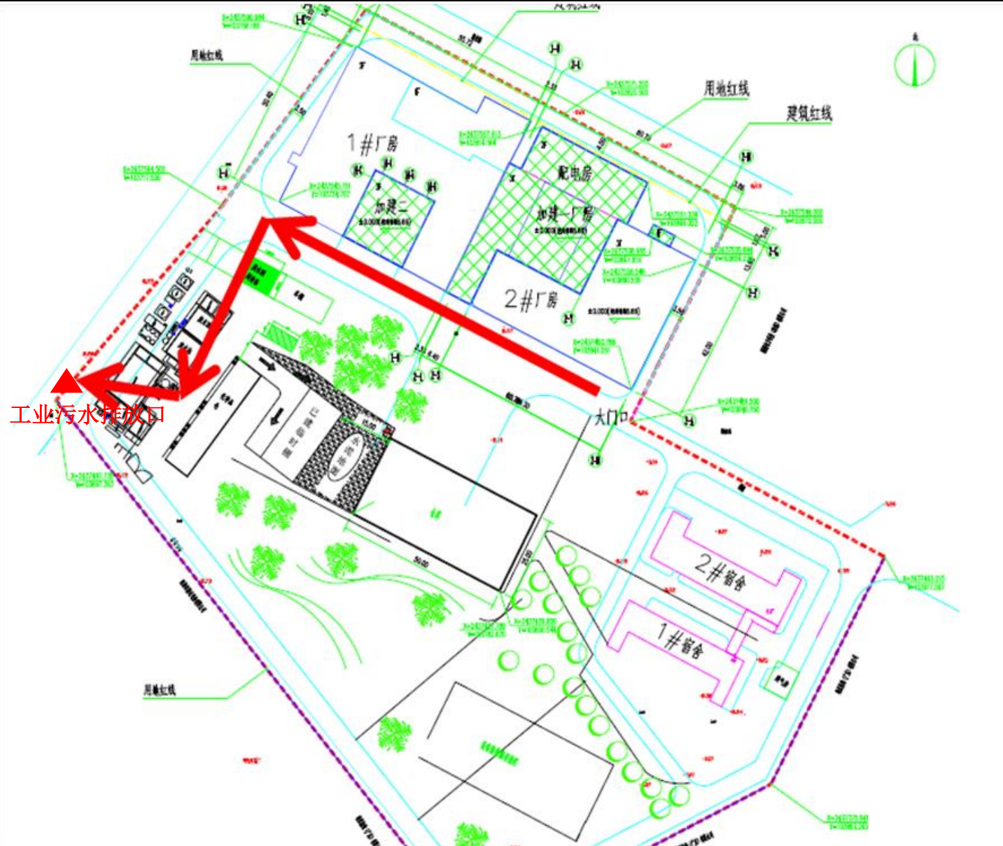
附图5 厂区工业污水管网走向图
