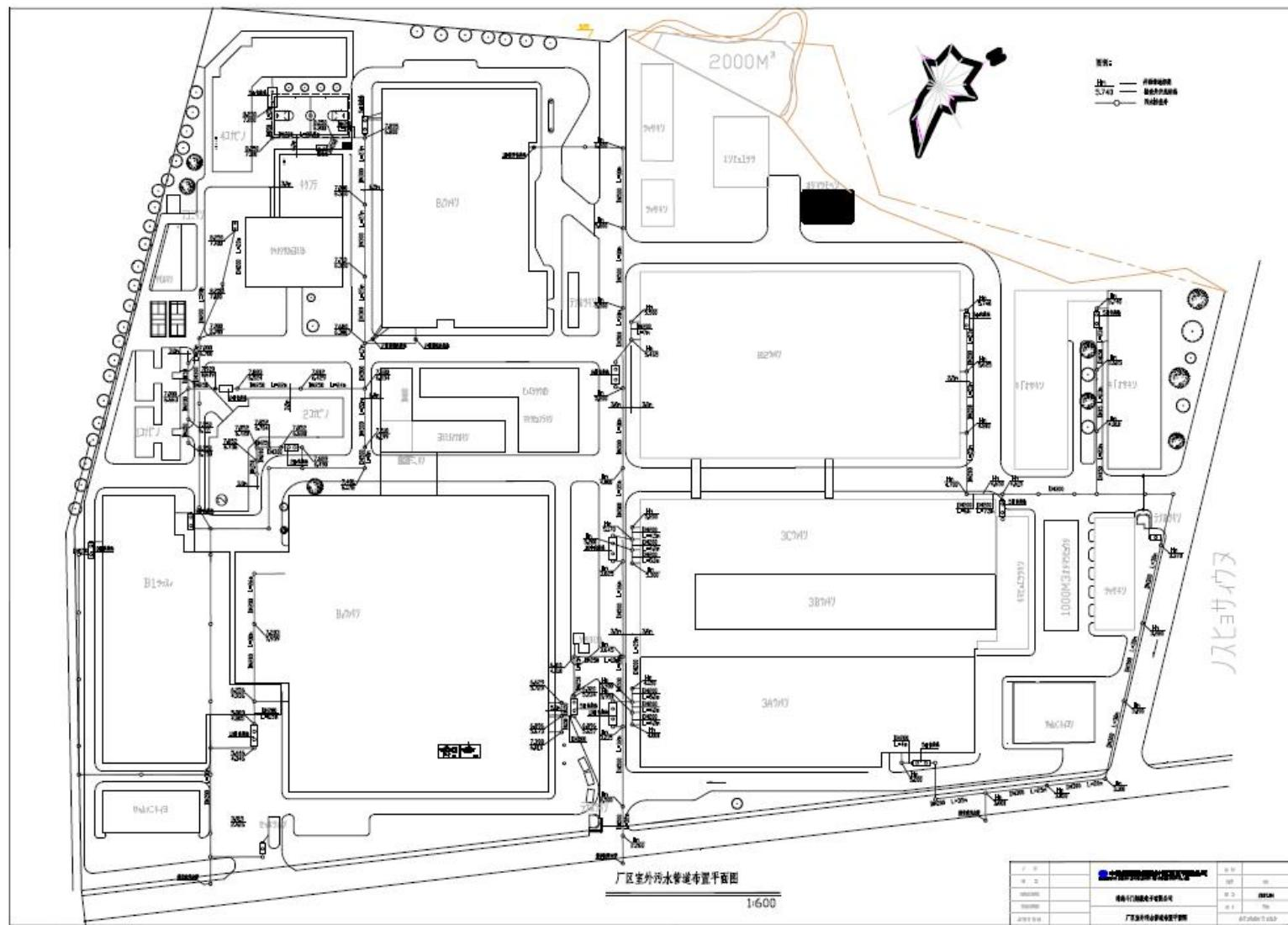
附图 5 企业所在厂区雨水管道总平面图
