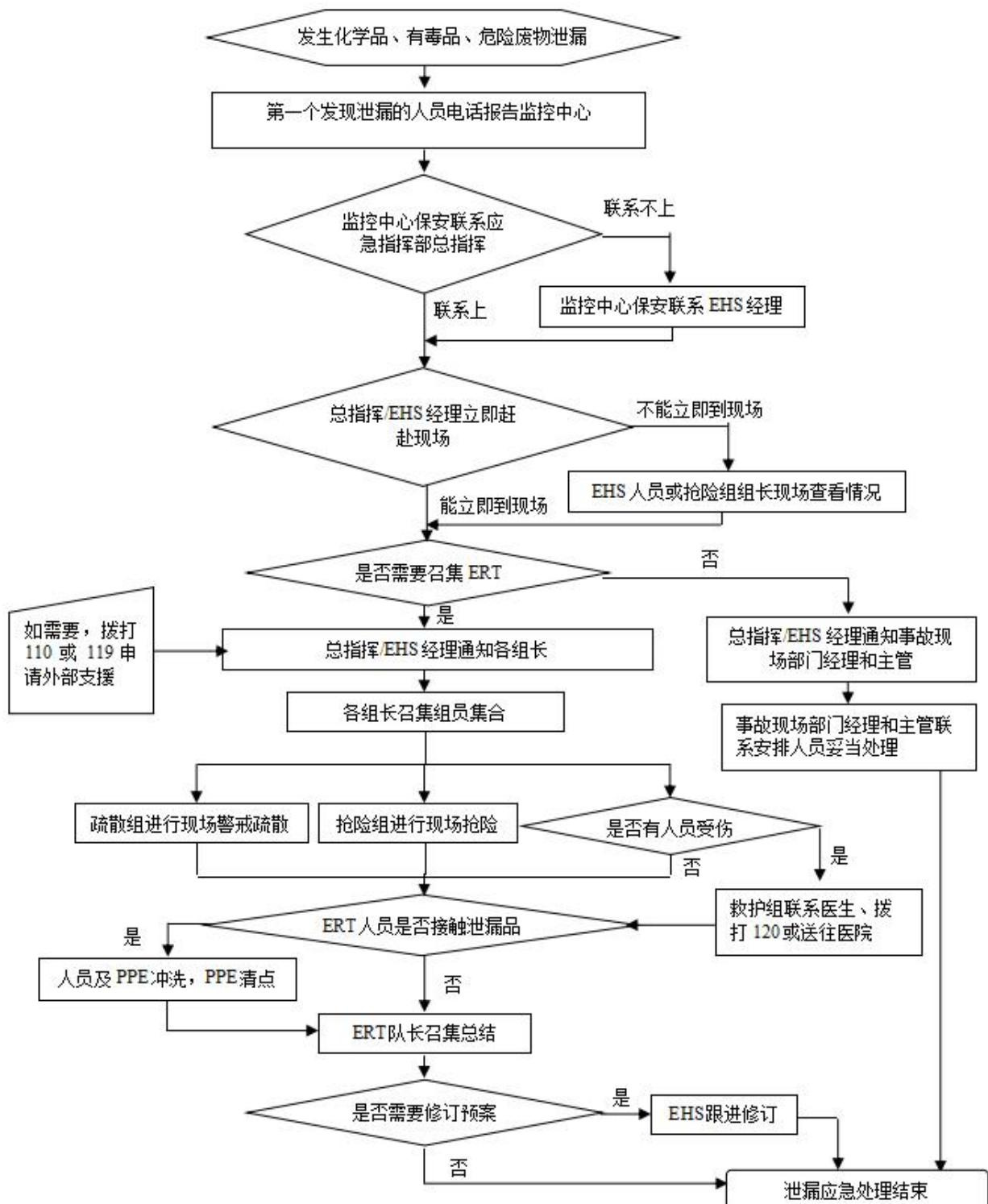
图 6.4-1 泄漏应急处置流程图
