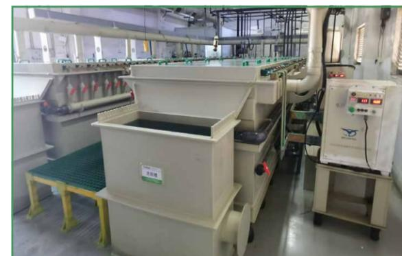
电解方式回收蚀刻废液中的铜，减少含铜废液
